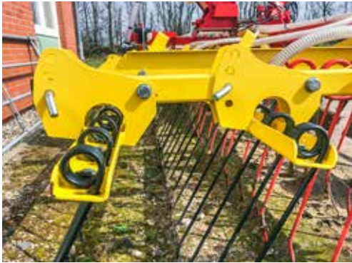
Das hintere Striegelfeld am APV-Striegel lässt sich manuell und einfach vierfach verstellen.
